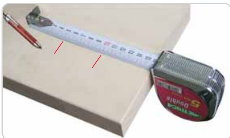
Graduation adhérente à la surface Die Teilung ist haftend auf der Oberfläche zu messen
